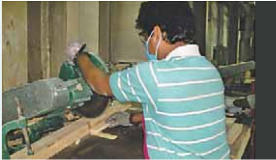
Mesh Gloves Used by Cutting Operator कटिंग ऑपरेटर द्वारा मेश दस्तानों का उपयोग
